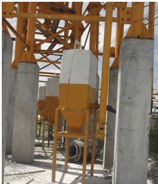
รูปเครื่องกรองฝุ่น ที่เกิดจากถังเก็บปูนซิเมนต์ผง
